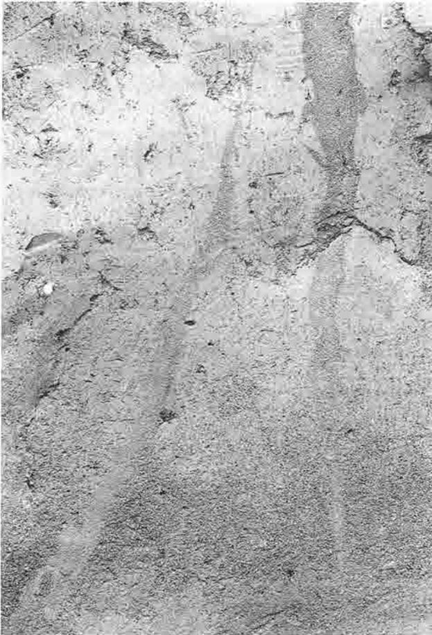
写真2 液状化跡の断面形
