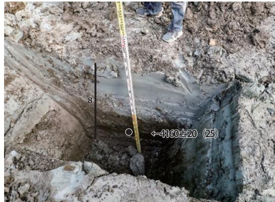
写真12 深掘トレンチの試料採取状況
