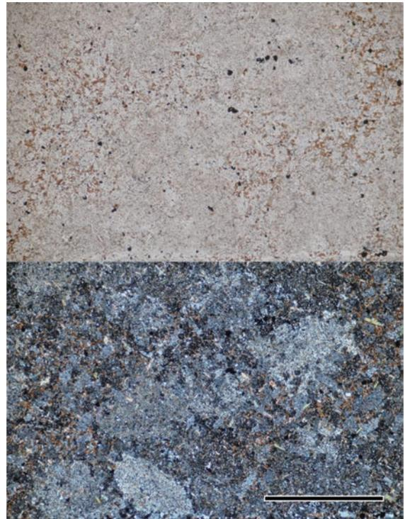
【写真4】 試料⑤の偏光顕微鏡写真(上:開放ニコル, 下:直交ニコル). スケールは2mm.
