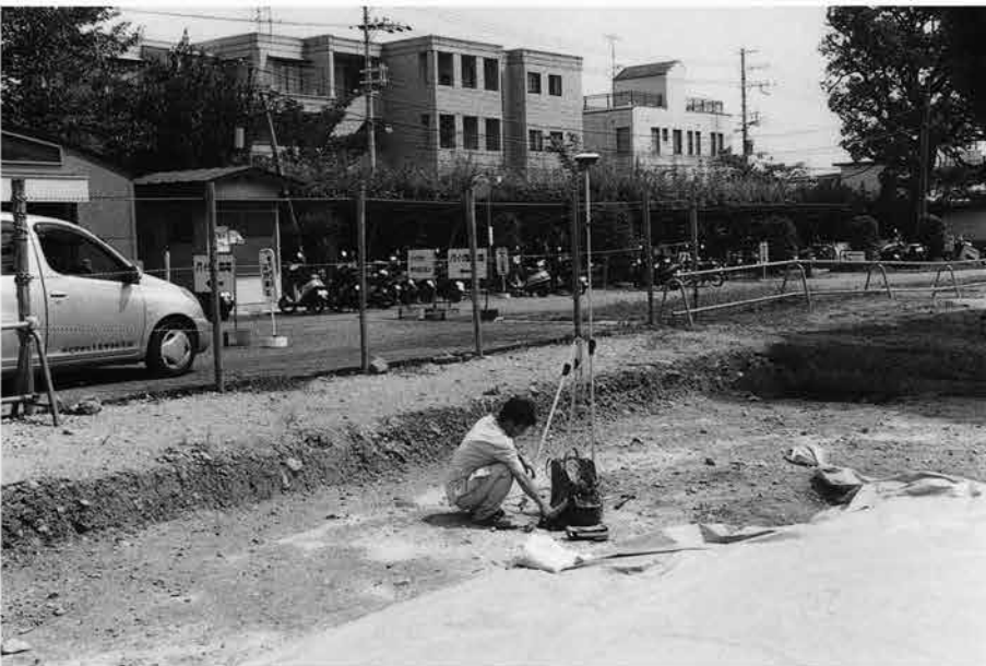
(2)GPSによる基準点測量 （A地区、北東から）
